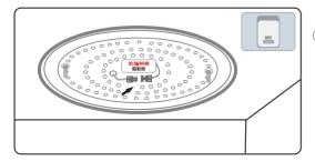
⑧【快接模組】電源線,連接於驅動器旁的橘色插孔,並確認是否插緊密合
