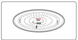
①請先分離【快接模組】連接處,並將【快接模組】 從底盤出線孔取出
